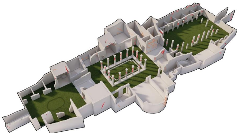
Modello tridimensionale schematico con l'individuazione del quadro fessurativo.
